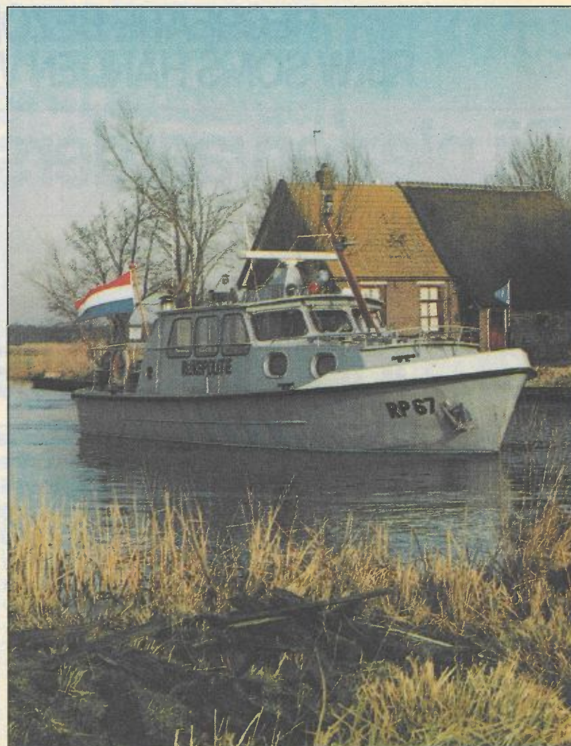
Het patrouillevaartuig is uitgerust met een marifoon, een mobilfoon, een radar en reddingsmateriaal.
