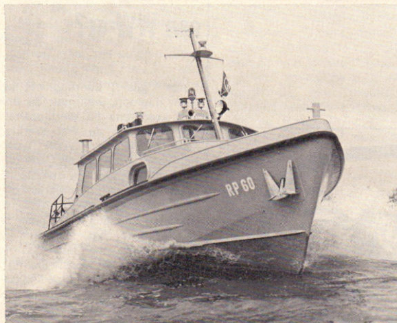
Patrouilleboot „RP 60“ ontwerp en bouw: Schottel Nederland Warmond N.V. eigenaar: Rijkspolitie te Water motor: Mercedes-Benz OM 346.
